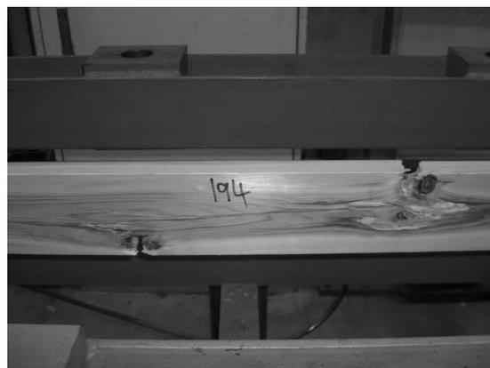
図3 引張り試験における破壊形態の一例
