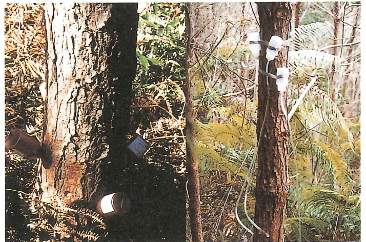
写真-14 マツノザイセンチュウ予防薬剤による試験状況
