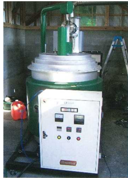
未利用木質資源の有効利用試験 (炭化炉)
