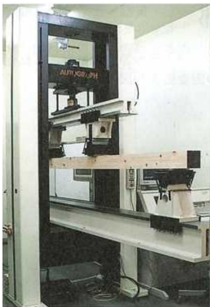
実大寸法による柱材の破壊強度試験
