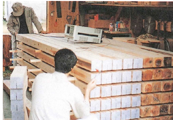
打撃音測定による木材強度性能（ヤング率）の測定
