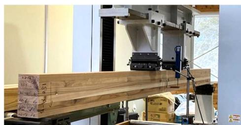
図4 曲げ強度試験
