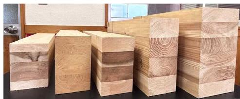
図3 作製した横架材の一例
