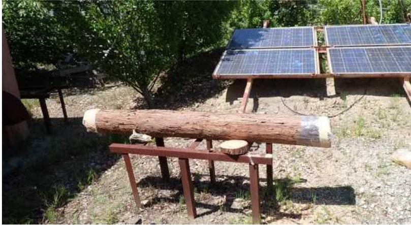
図1 林業試験場構内における皮付きヒノキ材の設置状況
