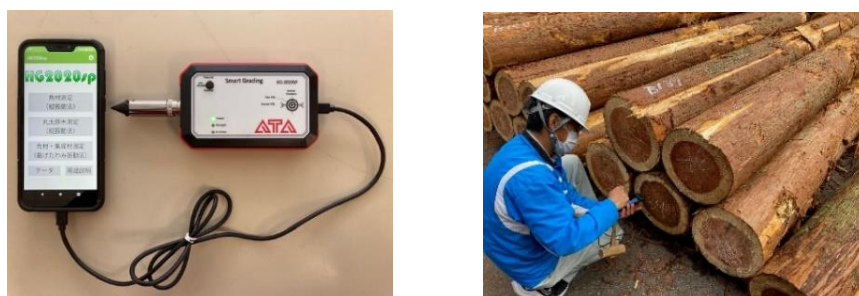
図 1 原木ヤング係数の測定
