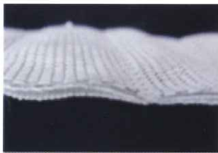
図1 高断熱資材 高断熱資材「YI冷/暖シート No.7」の断面 ポリエステル布（白色）2枚とアルミ薄片を編み込んだ布1枚を縫合している
