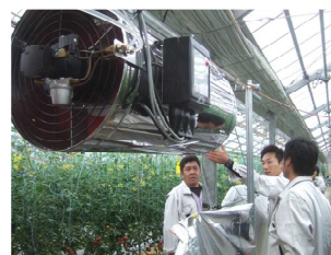
図2 現地ほ場で使用のCO 2 発生機 注) 1時間あたりのCO 2 発生量13m 3 施用条件: 7:30~16:30の間、 1時間に6分稼働
