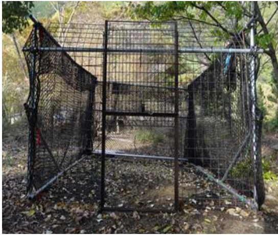
図1 不整地対応囲いワナの構造 (a: 前面 b: 側面)
