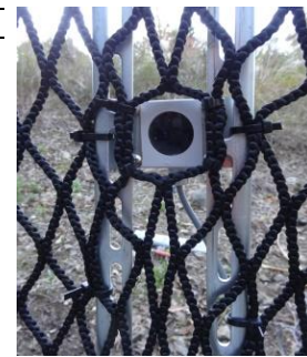
図2 電子トリガーのセンサー部のネットへの取り付け
