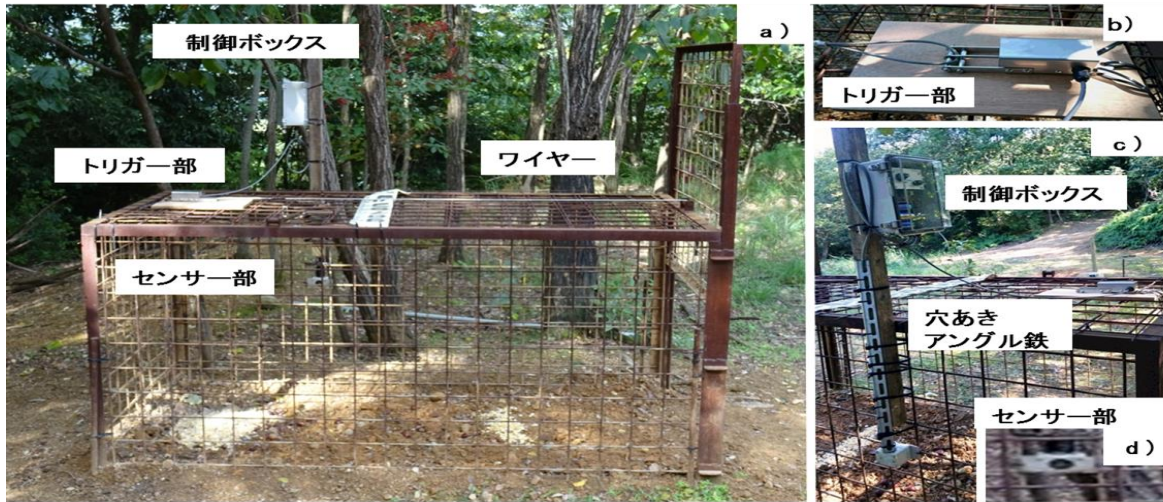
図1 電子トリガーの設置状況と仕様 a)全体像 b)トリガー部 c)制御ボックス d)センサー部
