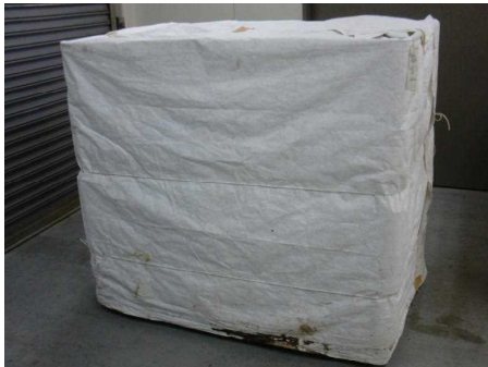
写真1 簡易貯蔵の様子 (縦置き、横4×縦2×4段)
