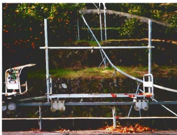
図1 荷台車を利用した簡易搭載装置
