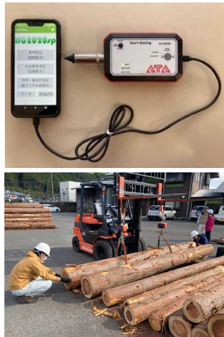
図 原木ヤング係数の測定 上段：簡易型強度測定器 下段：測定の状況
