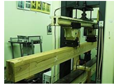
図3 曲げ破壊試験
