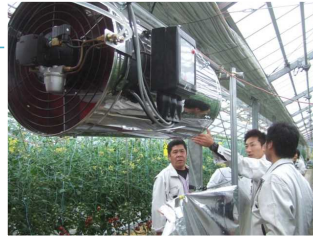
本試験で用いた CO 2 施用機
