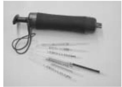
気体検知器(上)と気体検知管(下)
