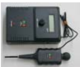
エコアナライザーで液体を吸引し、値（ppm）を読み取ります。
