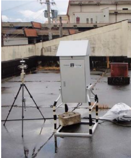
ダイオキシン類大気採取 (ハイポリウムエアサンプラー)
