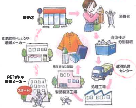
PET (ペット) ボトル・リサイクルのしくみ
