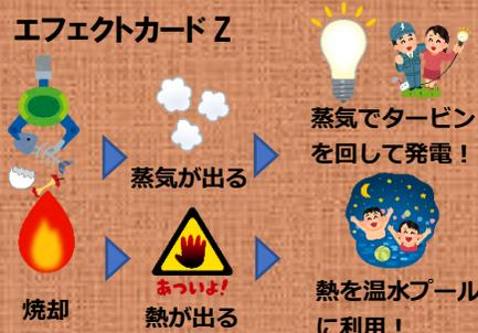
蒸気が出る 蒸気でタービンを回して発電! 熱が出る 熱を温水プールに利用!
