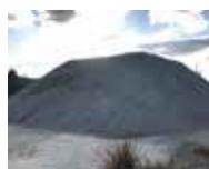
主にコンクリート廃材を破碎したリサイクル製品です。路盤材・基礎材・裏込材等に利用して頂けます。
