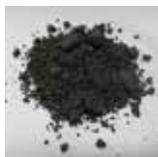
鉄鋼スラグ特有の潜在水硬性を活用したバラン舗装材で、簡易で安価な舗装資材として防草対策や林道・農道等に適した製品です。
