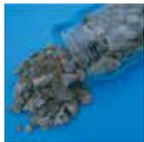
コンクリート、アスファルトガラを破碎した再生路盤材廃棄物になっても再度リサイクル可能（谷口工場）みなべ町谷口上山寄48-3
