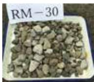
コンクリート廃材を破碎しリサイクルしたリサイクル製品です。主に路盤材として、利用して頂けます。
