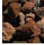
レンガや色瓦を主体として製造した再生砕石で、粒度を40mm以下に調整しております。
