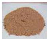
廃瓦を破碎処理し製造したリサイクル砂です。
