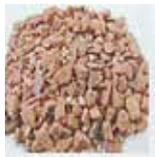
廃瓦を破碎処理し製造したリサイクル砂です。埋戻材・園芸用資材等、幅広く利用することができます。
