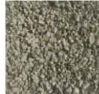
県内で排出された産業廃棄物(廃コンクリート)を骨材プラント(HAC100)により再生単粒度製品(リサイクル製品)です。
