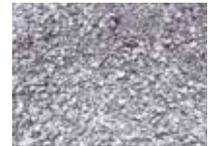
県内で排出された産業廃棄物(がれき類・汚泥)を破碎、混合し再生砕石(RC-30)の品質基準に適合させて商品化したリサイクル製品です。
