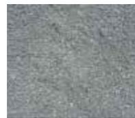
県内で排出された産業廃棄物(がれき類・汚泥)を10mm以下に破碎・精選した埋め戻し保護砂(リサイクル製品)です。
