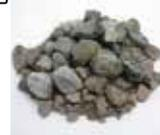
鉄鋼スラグを主原料とする上層路盤材で、JIS A5015に相当する製品です。潜在水硬性により長期にわたり路盤の強度が増加します。また、含水比の変化の影響を受けにくく、良好に締め固める事が可能であって、施工は一般の路盤材と同様に行う事が出来ます。
