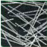
再生PETを原料とし、コンクリートとの付着性が大きく、コストパフォーマンスの高いコンクリート・モルタル補強用再生PET繊維です。
