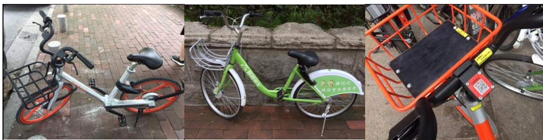
青島で見かけるシェア自転車。アプリでQRコードを読み取るとロックが外れる。
