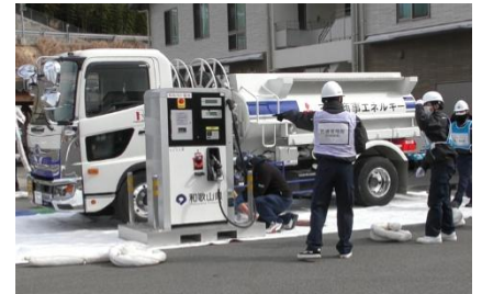
移動式給油機による給油
