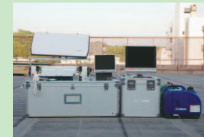
衛星可搬局(VSAT)
