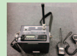
可搬型・携帯型無線機
