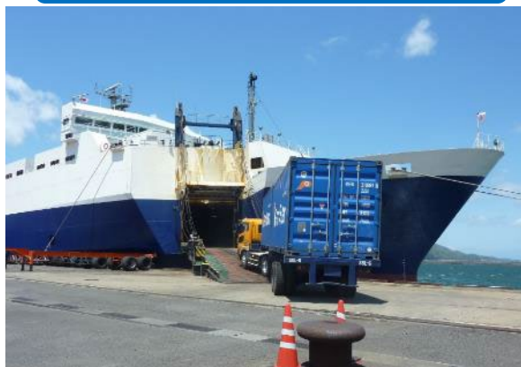
RORO船の荷役状況
