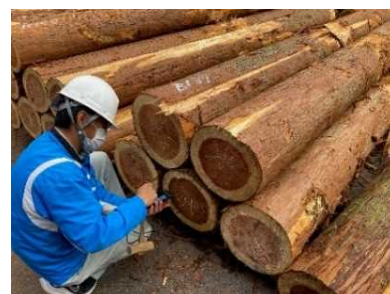
図 原木ヤング係数の測定 上段：簡易型強度測定器 下段：測定の状況
